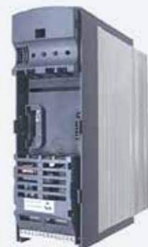
Alloggiamento modulo EM-ENC-01 sull'inverter
