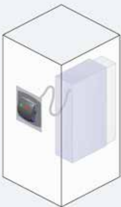
Remotazione all'esterno del quadro
