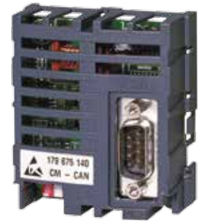
El micro-interruptor interno habilita la resistencia de terminación de línea incorporada en el módulo
