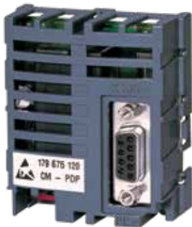
El micro-interruptor interno habilita la resistencia de 220 \Omega de terminación de red incorporada en el módulo.
